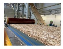
Wird aus schlanken langen 50-90mm Strands hergestellt, die Strands sind 0,4-0,6mm dick. Die Strands werden paralell zur Plattenlänge oder Plattenbreite ausgerichtet. Die OSB Platte wird mit Kunstharz zusammengeleimt.
